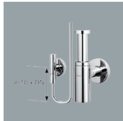
Ilustr. 1 – 17 Odcinek wychładzania armatury stojącej
