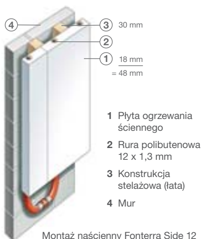
Montaż naścienny Fonterra Side 12
