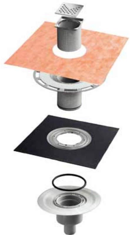
Idealne rozwiązanie do strefy natrysków: dwie warstwy uszczelniające – warstwa bitumiczna na betonie oraz uszczelnienie cienkowarstwowe pod płytkami.
